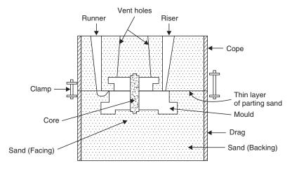
Fig. 6.4 A mould ready for pouring
